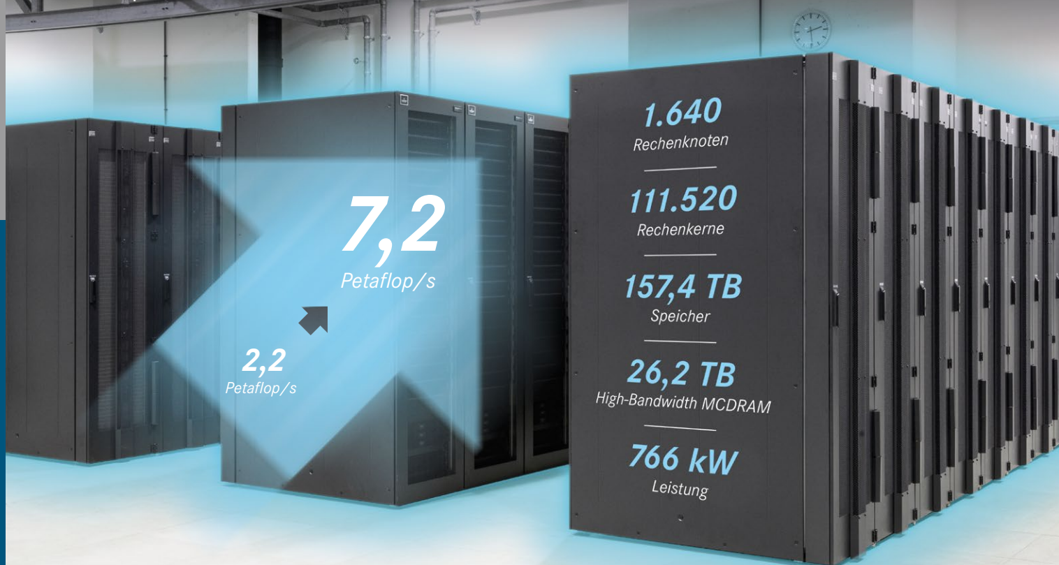
5-Petaflop/s-Booster in der Rechnerhalle des Jülich Supercomputing Centre (JSC)
