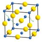
Normalerweise leitet ein flüssiger Elektrolyt Lithium-lonen während des Entladens von der Anode zur Kathode und isoliert die beiden Pole gleichzeitig elektrisch. Ein Festkörper kann diese Funktion aber auch übernehmen. Dafür geeignete Materialien haben Leerstellen in ihrer atomaren Gitterstruktur. Lithium-lonen (blau) können sie besetzen und sich so "hüpfend" durch den Festkörper bewegen.
